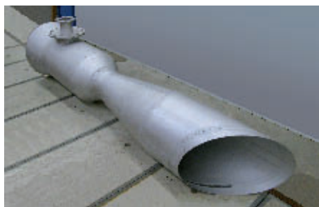
Lockstrompumpe zur Verbesserung der Auffindbarkeit von Fischaufstiegsanlagen.
